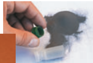
Wewnątrz naboju w plastikowej kapsułce umieszczony jest metaliczny proszek
