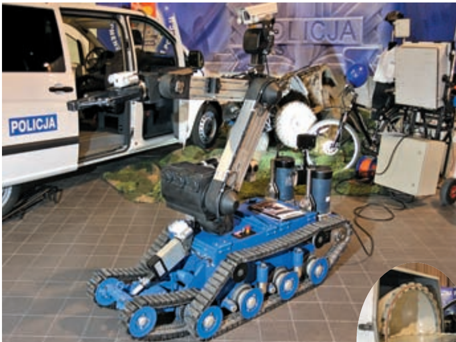
„Zrobotyzowane urządzenie SR 12”. Dla pirotechników. Zdalnie sterowane. Dzięki systemowi kamer można precyzyjnie naprowadzić na bombę...
