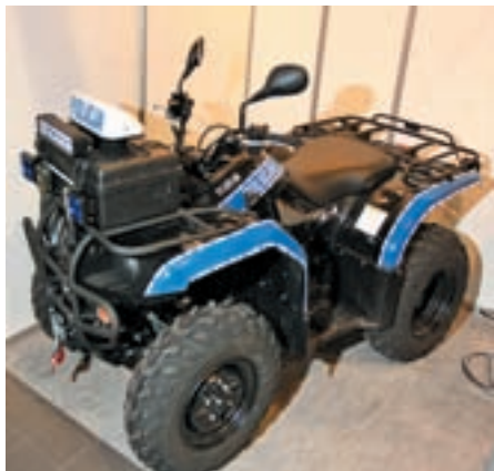
„Motocykl terenowy” służy do patrolowania tych terenów, gdzie żaden samochód nie wjedzie. Ma napęd na 4 koła, 350 cm 3 pojemności, wyciąga 70 km/h i posiada homologację. Gdyby się gdzieś zakopał, ma wyciągarkę (ekologiczną – drzewa nie zniszczy)
