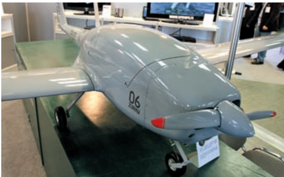
12 godzin lotu, maksymalnie 4 tys. metrów nad ziemią, z prędkością przelotową 100 km/h, (maksymalna prędkość – 150 km/h), 30 kg wagi. W pełni automatyczny start, lot i lądowanie. Nawigacja pokładowa, obserwacja, wykrywanie, lokalizacja obiektów. Ponadto patrolowanie, kontrola ruchu drogowego, pomoc przy wypadkach i katastrofach
