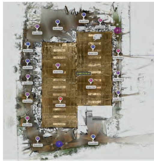
Szkielet finalny z miejsca zdarzenia po skanowaniu skanerem 3D. Widoczne punkty wskazują miejsca ustawienia urządzenia
