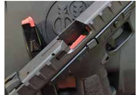
Jaskrawy donośnik amunicji po odciągnięciu zamka w tylne położenie wyraźnie wskazuje, że broń jest rozładowana
