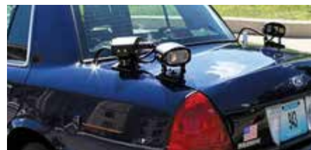
Około 71 proc. wszystkich amerykańskich departamentów policji używa systemu LPR – kamery mobilne zamontowane są na radiowozach
