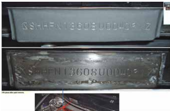
Sfalszowanie oznaczenia identyfikacyjnego pojazdu przez wspawanie numeru identyfikacyjnego VIN pochodzącego z innego pojazdu
