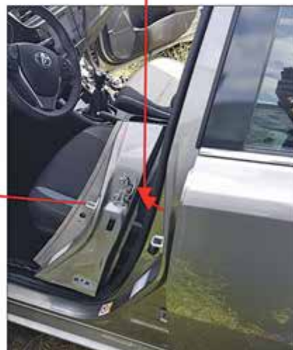
Widok miejsca po usuniętej tabliczce znamionowej celem sfałszowania oznaczenia identyfikacyjnego pojazdu przez wklejenie w to miejsce tabliczki pochodzącej od innego pojazdu marki Toyota model Auris – widocznej na wyciętym elemencie, tj. słupka drzwiowego
