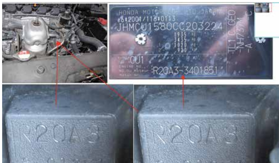
Oryginalne oznaczenie identyfikacyjne silnika dla pojazdu marki Honda występujące na bloku silnika, a także na tabliczce znamionowej pojazdu
