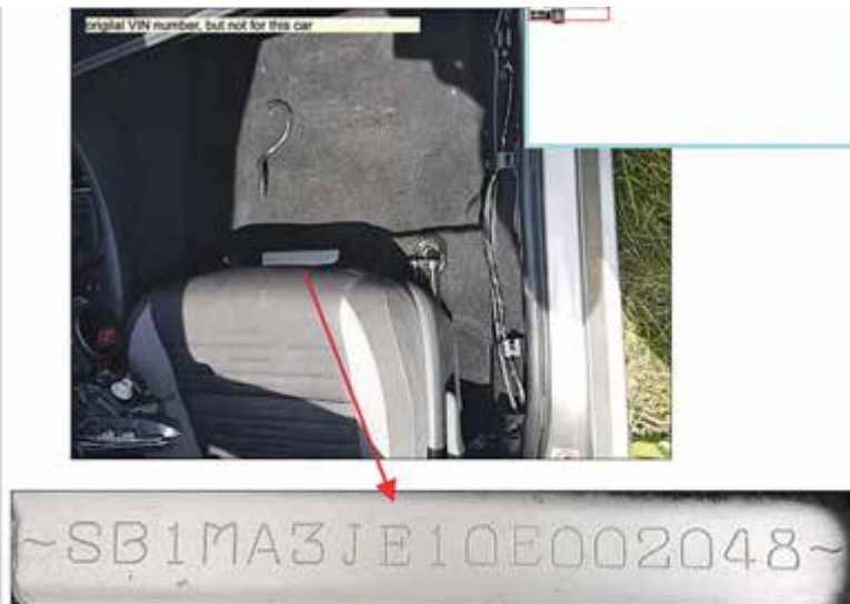
Przykład sfalszowanego oznaczenia identyfikacyjnego przez wspawanie do pojazdu elementu podłogi z numerem identyfikacyjnym VIN pochodzącym z innego pojazdu
