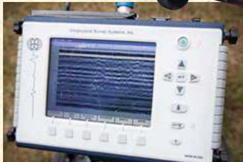
Ekran georadaru wyświetla struktury ścian i podłogi w formie wykresów. Do ich odczytu trzeba mieć wiedzę i doświadczenie
