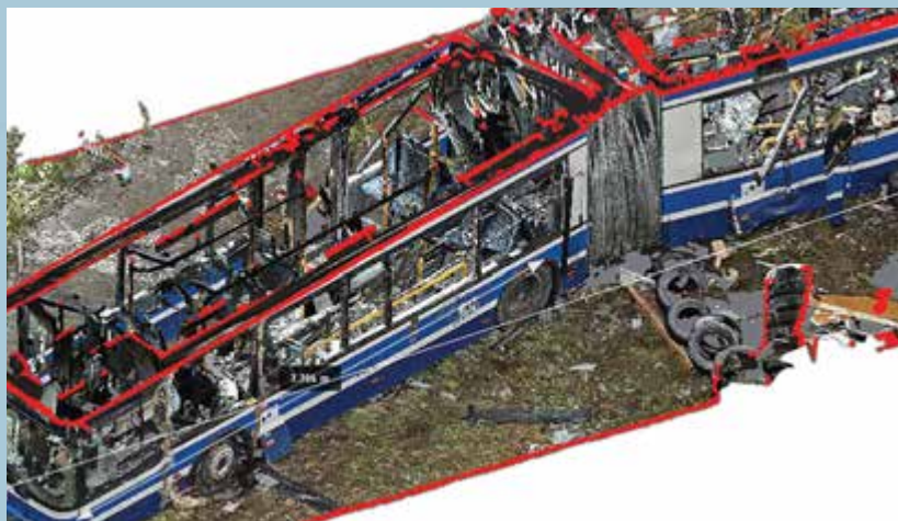
Kompleksowa dokumentacja wieloaspektowego miejsca zdarzenia. Pojazd zdewastowany eksplozją w wyniku ataku terrorystycznego. Dokumentacja wykonana z zastosowaniem technologii laserowego skanowania 3D
