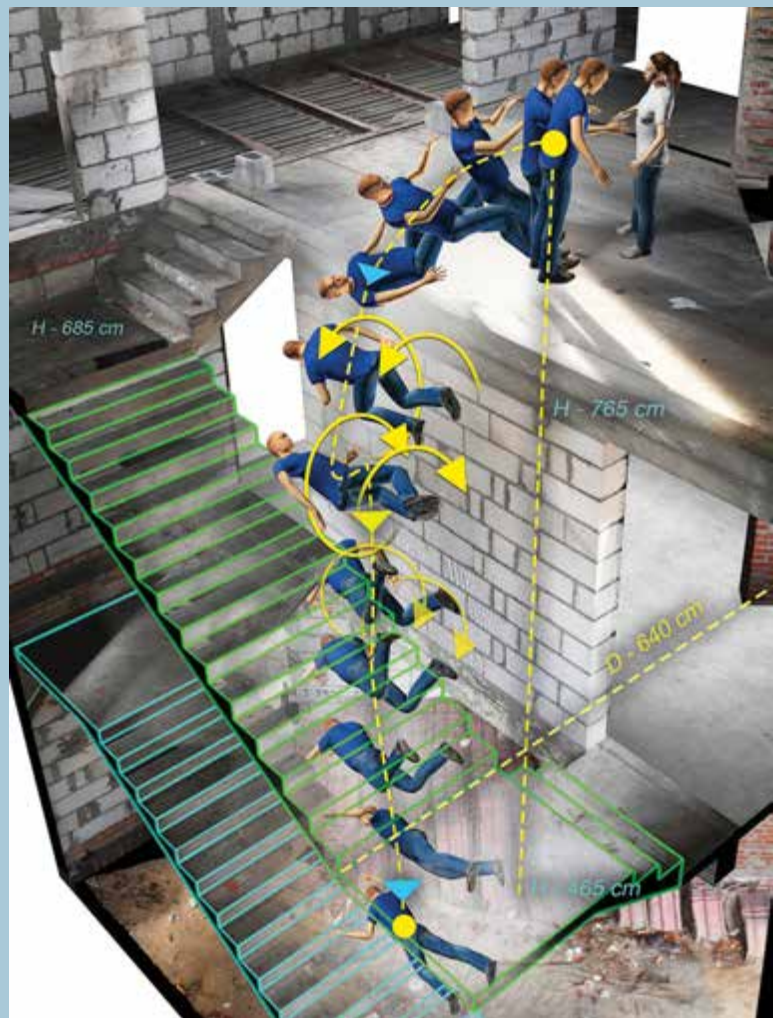
Rekonstrukcja przebiegu upadku z wysokości na podstawie analizy doznanych obrażeń w odniesieniu do topografii duszy klatki schodowej
