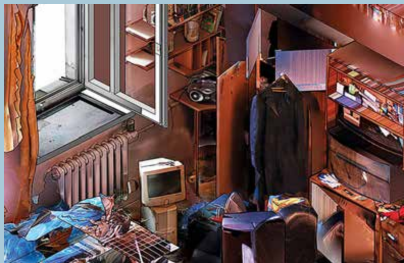
Trójwymiarowy model miejsca zdarzenia utworzony z zastosowaniem rekonstrukcji fotogrametrycznych w oparciu o dowodowe zdjęcia archiwalne
