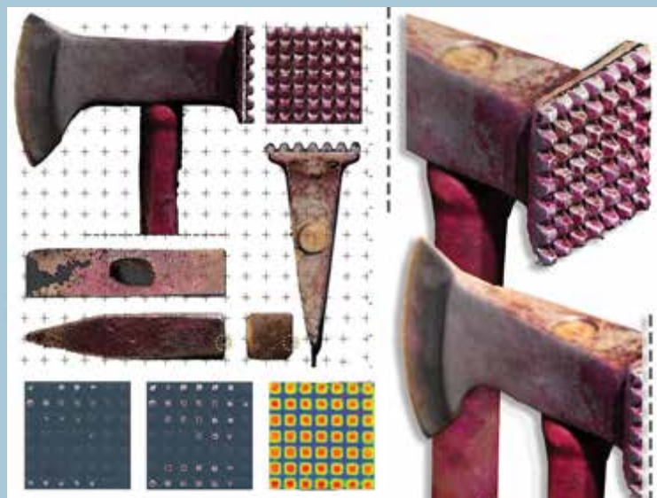
Skan 3D dowodowego narzędzia z uwzględnieniem analizy zużycia powierzchni czynnej obuśa tłuczka
