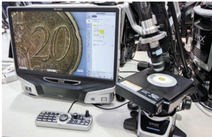
Cyfrowy mikroskop 3D, który może być wykorzystywany w badaniach mechanoskopijnych i balistycznych
