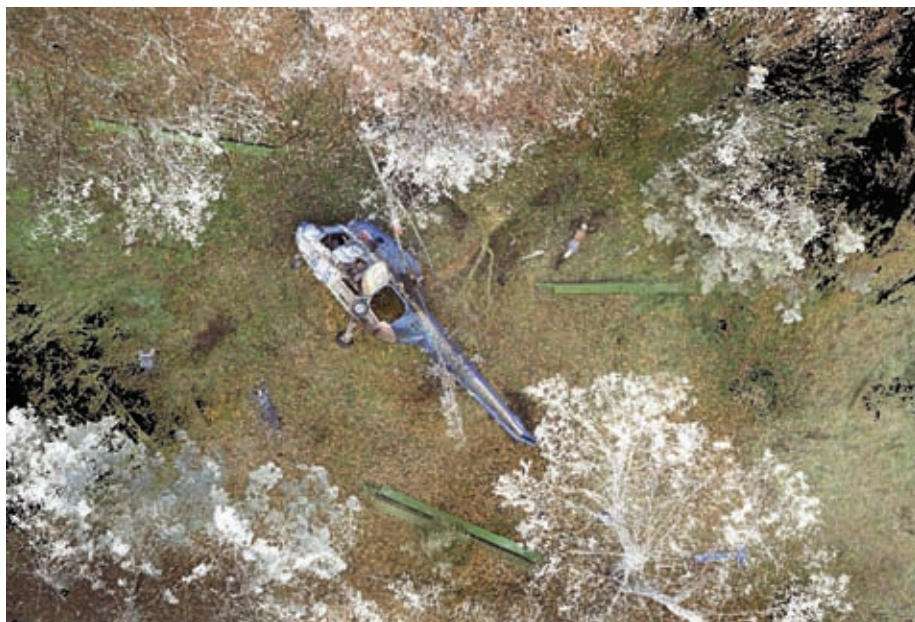
Wizualizacja miejsca zdarzenia w technice skaningu laserowego – wartością dodaną jest możliwość obejrzenia miejsca zdarzenia „z lotu ptaka”, choć w rzeczywistości efekt ten uzyskuje się wyłącznie z wykorzystaniem skaningu naziemnego
