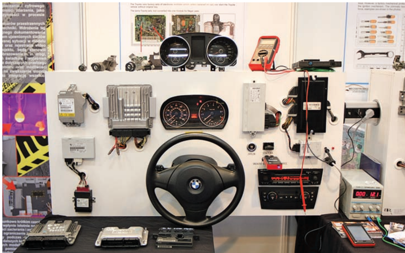
Na stoisku CLKP pokazano stanowisko prototypowe do pozyskiwania w celach procesowych informacji zakodowanych w podzespołach elektronicznych samochodów. Przy jego użyciu można ustalić m.in. zapisany w nich tzw. VIN, czyli numer identyfikacyjny pojazdu
