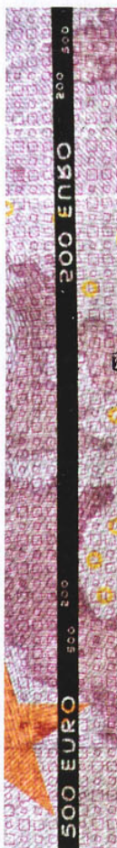
2. Nitka zabezpieczająca na banknocie 500 euro obserwowana w świetle przechodzącym
