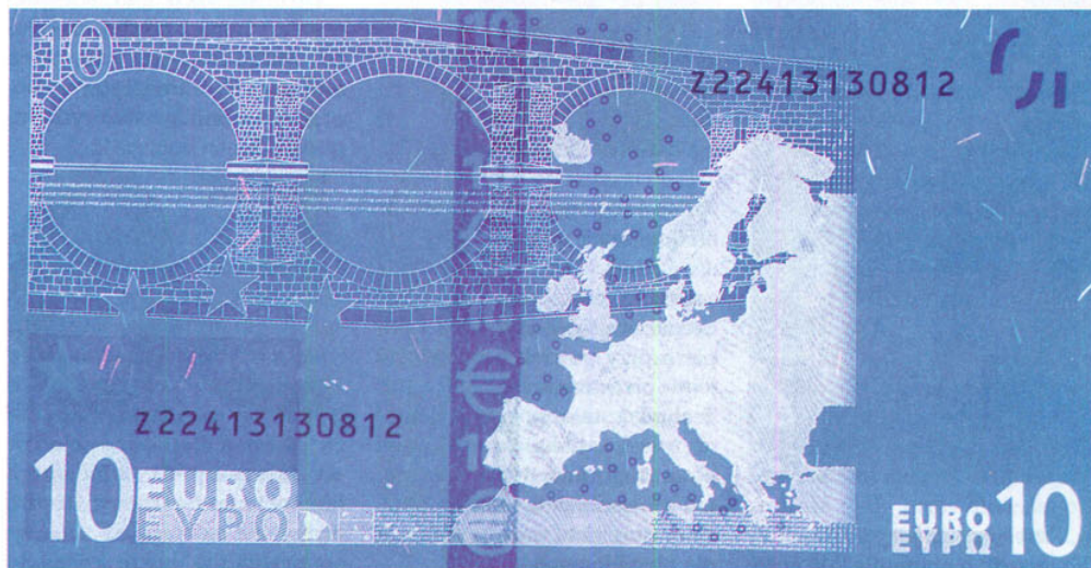
14. Zabezpieczenia na przedniej stronie banknotu o nominale 10 euro widziane w oświetleniu UV
