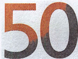
10. Zabezpieczenie nominalu banknotu na banknocie 50 euro wykonane techniką stalorytniczą
