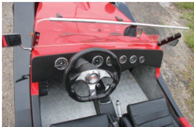
Na desce rozdzielczej zamontowane są zegary od skody 120
