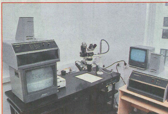
Biurowisko PTK: wideoespektroskop do badania autentyczności dokumentów oraz prezentacja wyników badań dokumentów, banknotów, czeków, pisma ręcznego, śladów linii papilarnych
