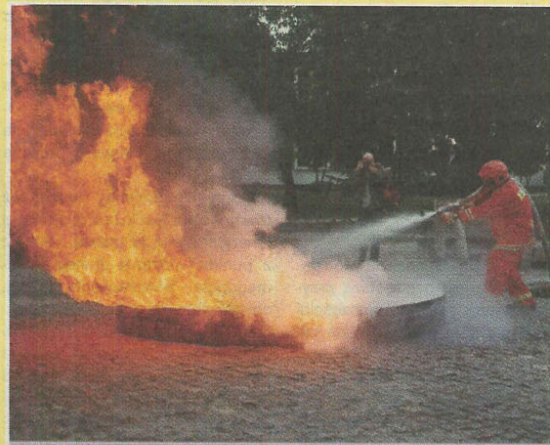
Do ugaszenia tego ognia wystarczyło pół minuty i 6 litrów wody w postaci mgły (na zdjęciu dr Ludomir Duda gasi pożar oleju napędowego)
