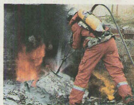
Sprzęt do gaszenia pożarów „przez mury”. Najpierw strumień wody drąży dziurę w ścianie
