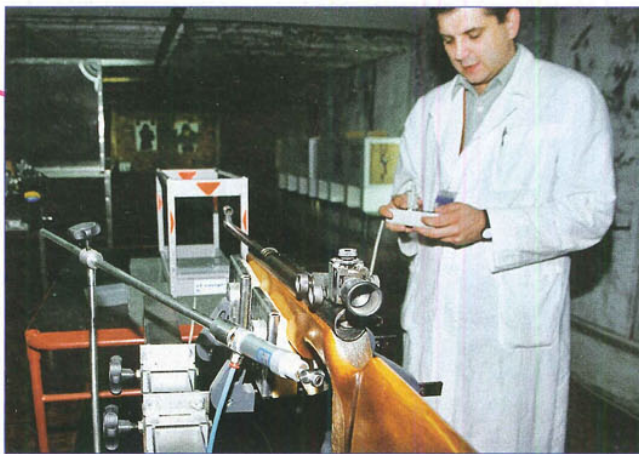
Tak wygląda stanowisko do badań prędkości, a tym samym energii, wyrzeliwanych pocisków
