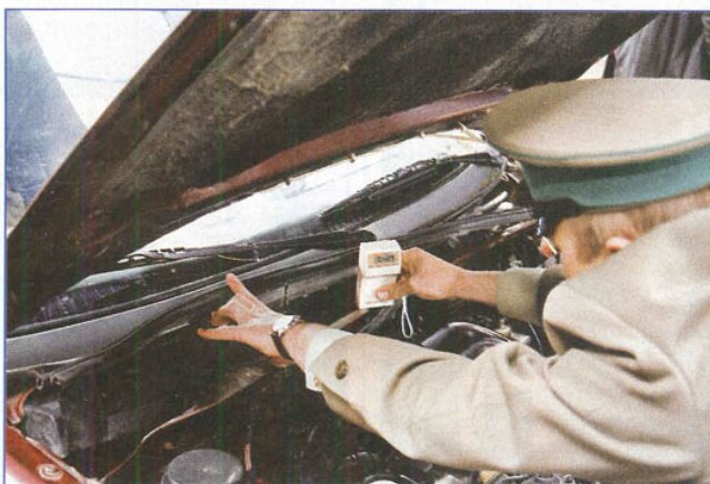
Defektoskop stalomagnetyczny to urządzenie proste, acz niezawodne. W sposób nieinwazyjny potrafi ujawnić wszelkie nieprawidłowości na lakierowej powłokę karoserii samochodu
