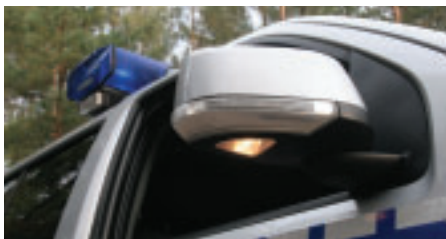
Duże lusterka zintegrowane z kierunkowskazem i lampką oświetlającą miejsce, w którym otwiera się drzwi
