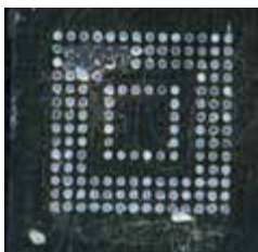
Miejsce po wylutowaniu kości pamięci z widocznymi śladami oderwanych pinów
