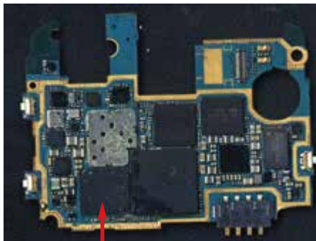
Kość pamięci zawierająca dane znajduje się na odwrotnej części płyty głównej
