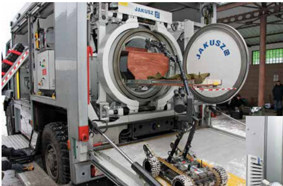
Ładunek ładunku wybuchowego z wykorzystaniem robota
