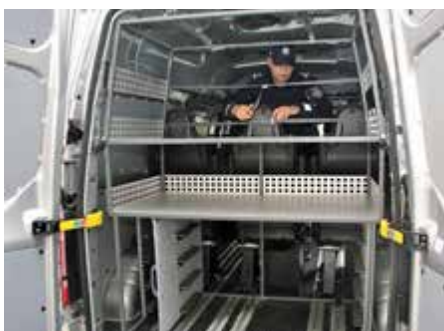
Wersja wypadowa ze stelażami na sprzęt NPP
