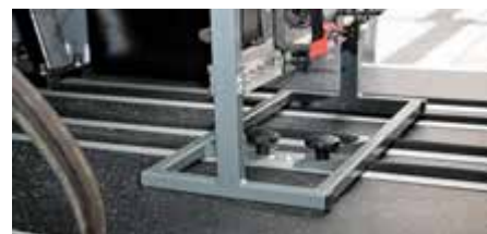
Demontowalny stolik oraz uchwyty na długą broń zebrały w testach najniższe oceny i będą przeprojektowane
