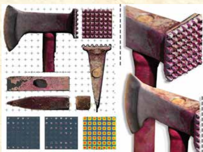
Skan 3D dowodowego narzędzia z uwzględnieniem analizy zużycia powierzchni czynnej obucha tłuczka
