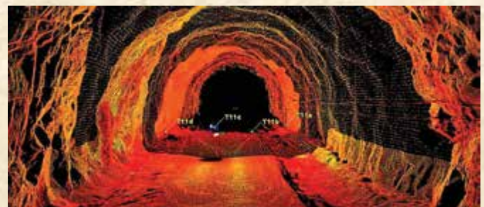
Inwentaryzacja przestrzeni sztolni. Możliwość rejestracji obrazu w ekstremalnie trudnych warunkach oświetlenia, przestrzeni, klimatu otoczenia i transportu sprzętu
