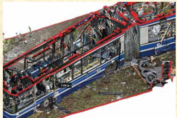
Kompleksowa dokumentacja wieloaspektowego miejsca zdarzenia. Pojazd zdeformowany eksplozją w wyniku ataku terrorystycznego. Dokumentacja wykonana z zastosowaniem technologii laserowego skanowania 3D
