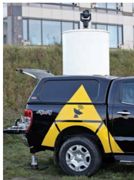
System antydronowy do wykrywania, identyfikacji i neutralizacji dronów składa się m.in. z radaru z kamerą
