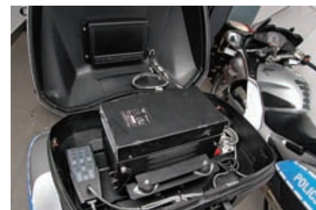
Sposób zamontowania wideorejestratora na motocyklu
