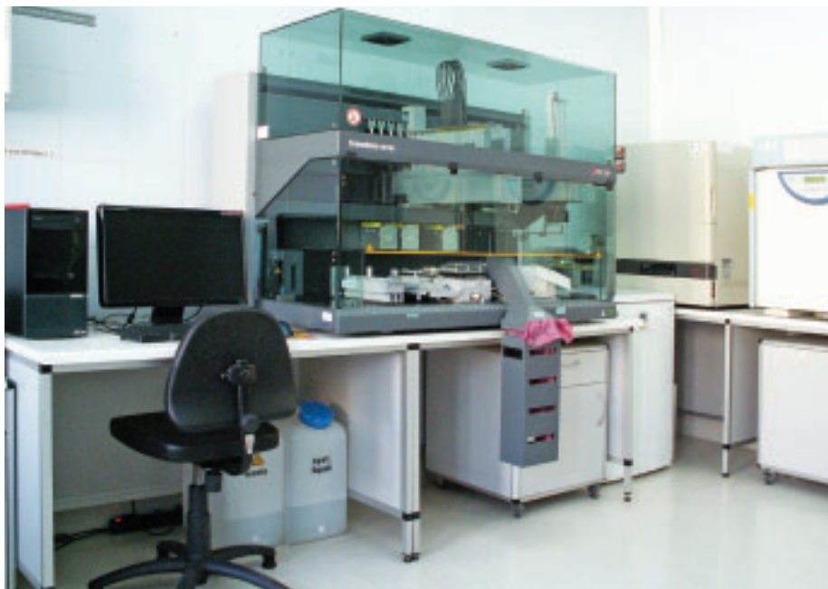
Stacja robocza Tecan EVOLution™ 150 służąca do ekstrakcji DNA metodą magnetyczną
